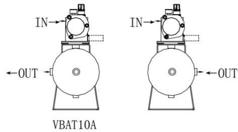
⑥安装：请使用附属的内六角螺栓沿对角安装。
