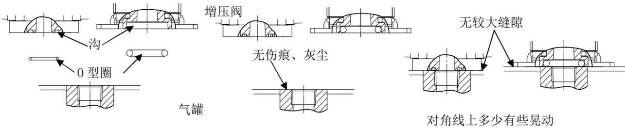
⑤确认安装方向：在气罐 VBAT10A1-※上安装增压阀 VBA2 时，可根据用途变更增压阀的 IN 方向、气罐的 OUT 方向。
