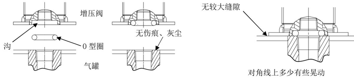
⑤ 安装方向确认：根据用途可变更增压阀 IN 方向、气罐的 OUT 方向。
