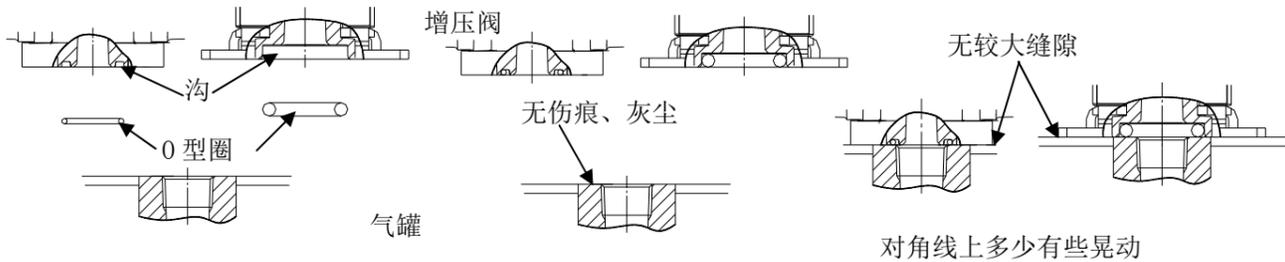
⑤确认安装方向：在气罐 VBAT10S1-※上安装增压阀 VBA2 时，可根据用途变更增压阀的 IN 方向、气罐的 OUT 方向。
